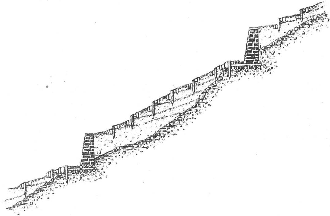
Fig. 1. Sohlenversicherung mittels Thalsperren und Schwellen bei aufgeforstetem Einzugsgebiet.
