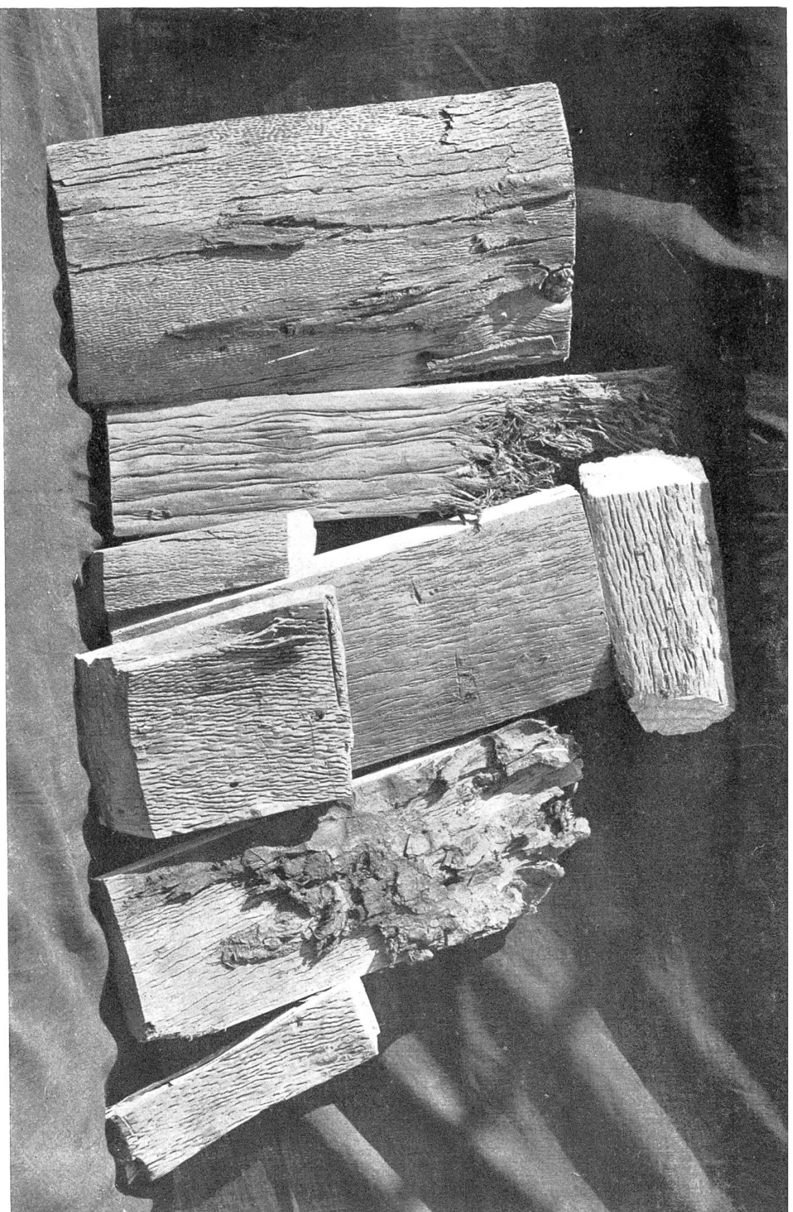
Fig. 1. Nagelholztypen, die Färbungen auf der Splintoberfläche zeigend.
