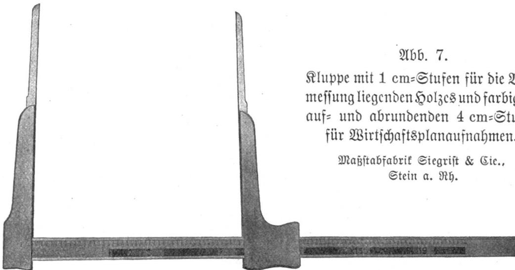
Bei diesen Kluppen wurden die großen Stufen mit verschiedenen Farben bemalt und mit großen Ziffern von 1 an numeriert, wodurch die Ablesungen sehr erleichtert und Verwechslungen der Skalen ausgeschaltet werden. An die Farbe knüpft sich nämlich sehr bald die Vorstellung einer Zahl, wie bei den Nummernschildern der Straßenbahnen, so daß Fehlablesungen sozusagen nicht mehr vorkommen.
