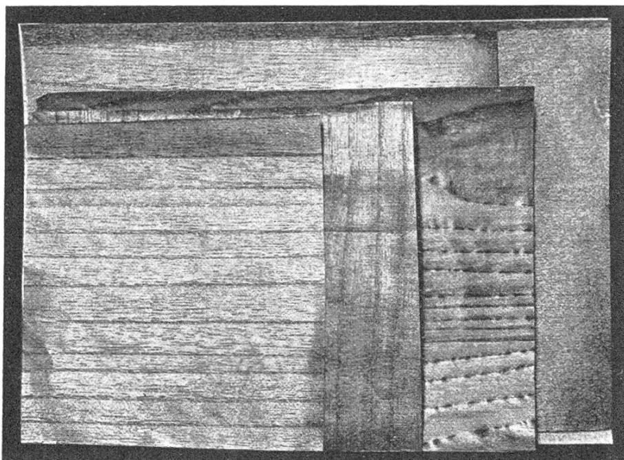
längere Zeit ins Wasser, so löst sich die Holzschicht von der Papierschicht ab und man kann die etwa  $\frac{1}{50}$  Millimeter dicken Schnitte auch im durchfallenden Licht unter dem Mikroskop betrachten. Die Holzschicht besteht aus ein bis mehrere Zentimeter breiten, 50 bis 80 Zentimeter langen nebeneinander geklebten, tangential geschnittenen Holzstreifen.
