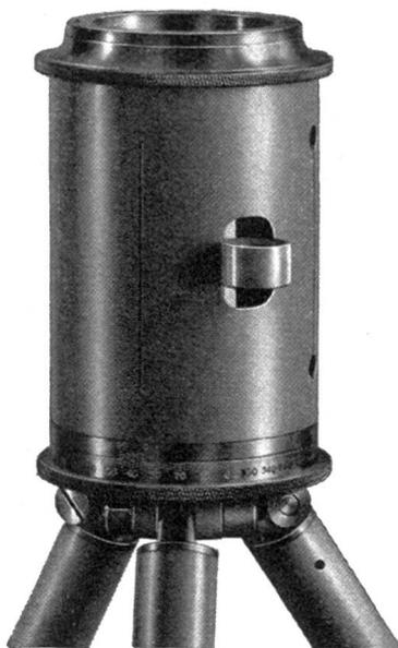
als ein zylindrisches Rohr, mit Dosenlibelle und vier genau rechtwinklig gefrästen Visierschlitzern versehen — dient zum Abstecken von rechten Winkeln in kupiertem Gelände. Das interessanteste Modell ist die Winkeltrommel, welche nebst der Vorrichtung zum Abstecken rechter Winkel im Deckel einen *Flüssigkeitskompass* trägt. Mit diesem können kleine Kompasszüge ausgeführt werden. Die Magnetonadel bewegt sich in einer Flüssigkeit, wodurch
