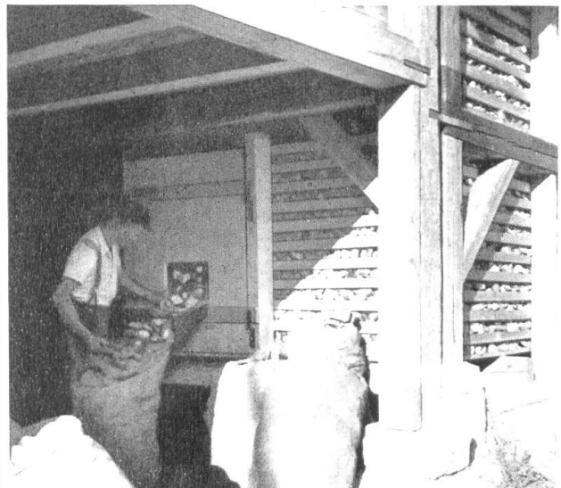
Bild 8. Trockenes Gasholz wird aus einem der vier Lagersilos in Säcke abgefüllt. Mit Hilfe eines höher oben angebrachten Schiebers kann Gasholz auch in offene Lastwagen abgelassen werden.
