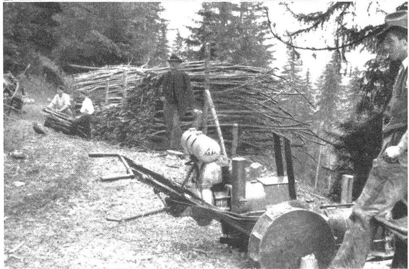
Der Zugmotor « Motrac ». Im Hintergrund der ankommende Schlitten. Das Zugseil läuft über zwei ob dem Weg befestigte Rollen.
