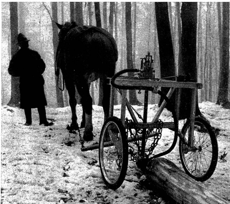
Bild 2. Zugkraftmessung beim Rücken mit Hilfe eines Meßwagens zum Mitführen des Registriergerätes, mit automatischem Vorschub der Diagrammrolle in Abhängigkeit vom zurückgelegten Weg.
