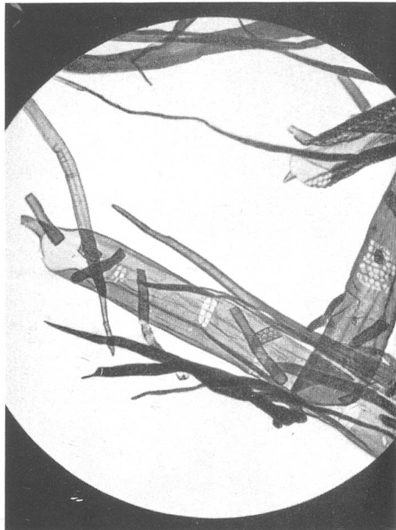
Abb. 6 130× Pappelfasern und Gefäßzellen
