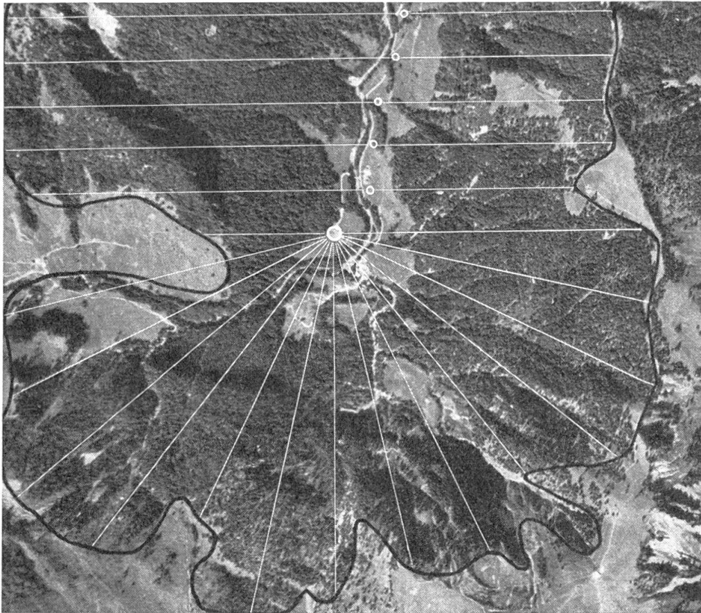
Die Aufzeichnungen auf diesem Bild zeigen schematisch das System der Walderschließung mit dem Seilkran. Die Seillinien können entsprechend den Lagerplätzen an der Straße angelegt werden. Sie brauchen nicht parallel und in gleichmäßigen Abständen zu sein. Normalerweise beträgt die Zuzugsdistanz pro Seite des Seiles 50 bis 75 m Weiße Striche = Seillinien; weiße Ringe = Ablagerungsplätze für das Holz an der Straße; dicke Linie = Waldgrenze
