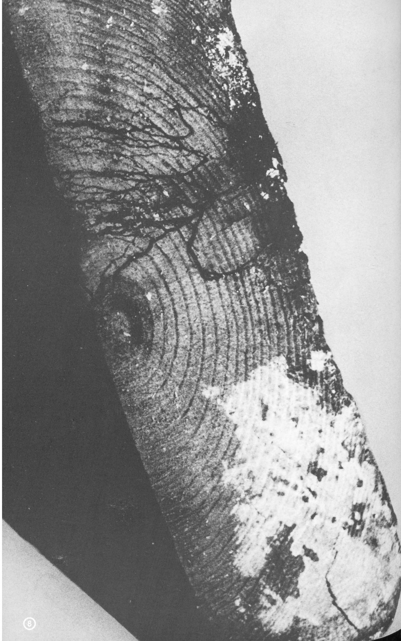
In andern Fällen entstanden Kellerschwammschäden als Folge der Verwendung von zu feuchtem Holz oder bei undicht gewordenen Zentralheizungsleitungen bei einer Bodenheizung. Ungenügende Kenntnisse der Entwicklungsbedingungen der Pilze wie auch der Eigenschaften der verwendeten Materialien oder unsorgfältige Durchführung der Installationsarbeiten sind hier die Ursachen der Entstehung der Schäden.
