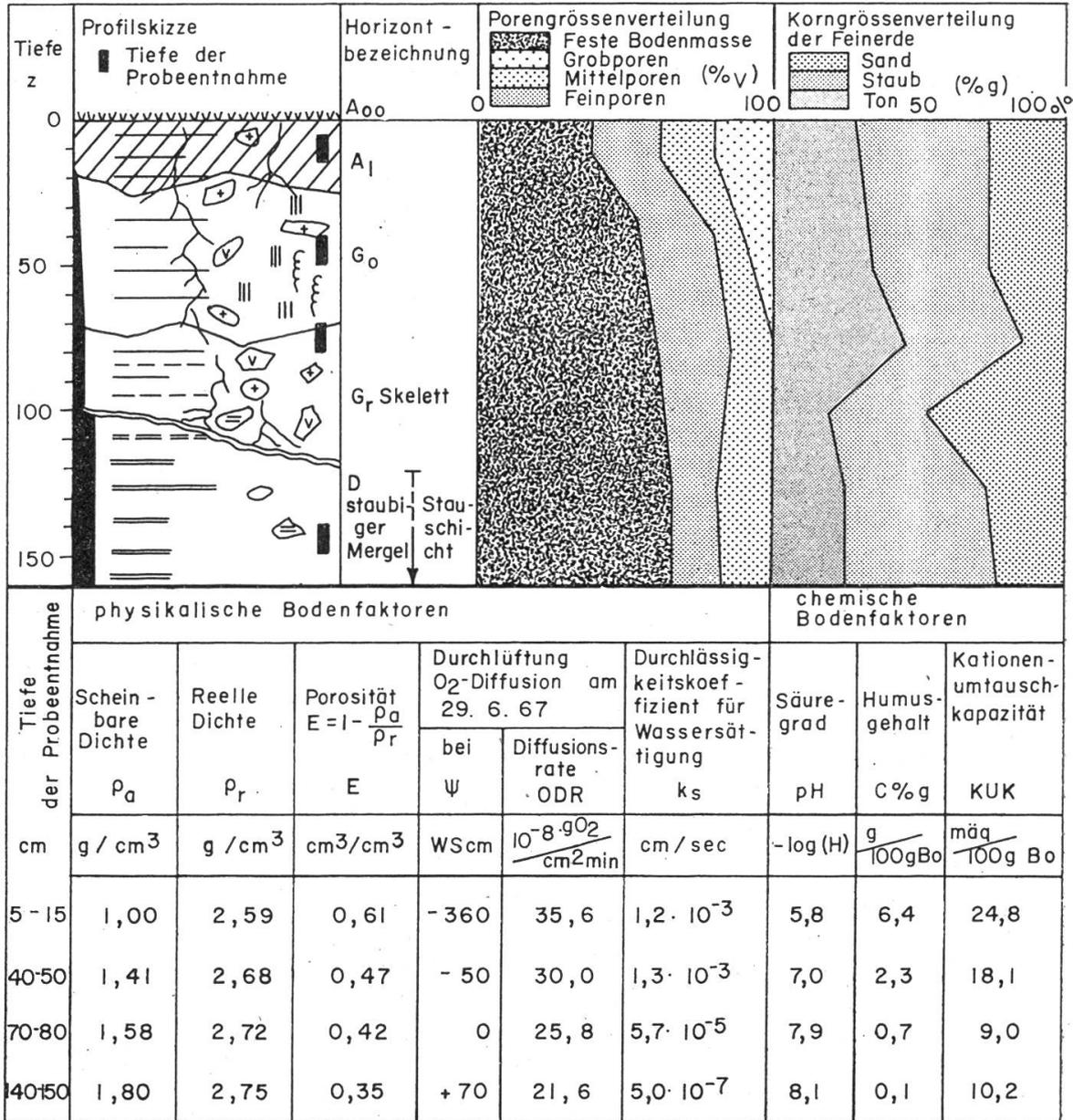
Der Oberboden (0 bis 50 cm) ist locker, gut drainiert bzw. durchlüftet. Man beachte das große Porenvolumen von 61 %<sub>v</sub> im A<sub>1</sub>-Horizont. Der humusreiche A<sub>1</sub>-Horizont und der darunterliegende, fleckig-oxydierte G<sub>0</sub>-Horizont sind gut mit Nährstoffen versorgt. Die Umtauschkapazität beträgt 25 bzw. 18 mäq. pro 100 g Boden. Die Oxydationsflecken deuten an, daß der Was-
