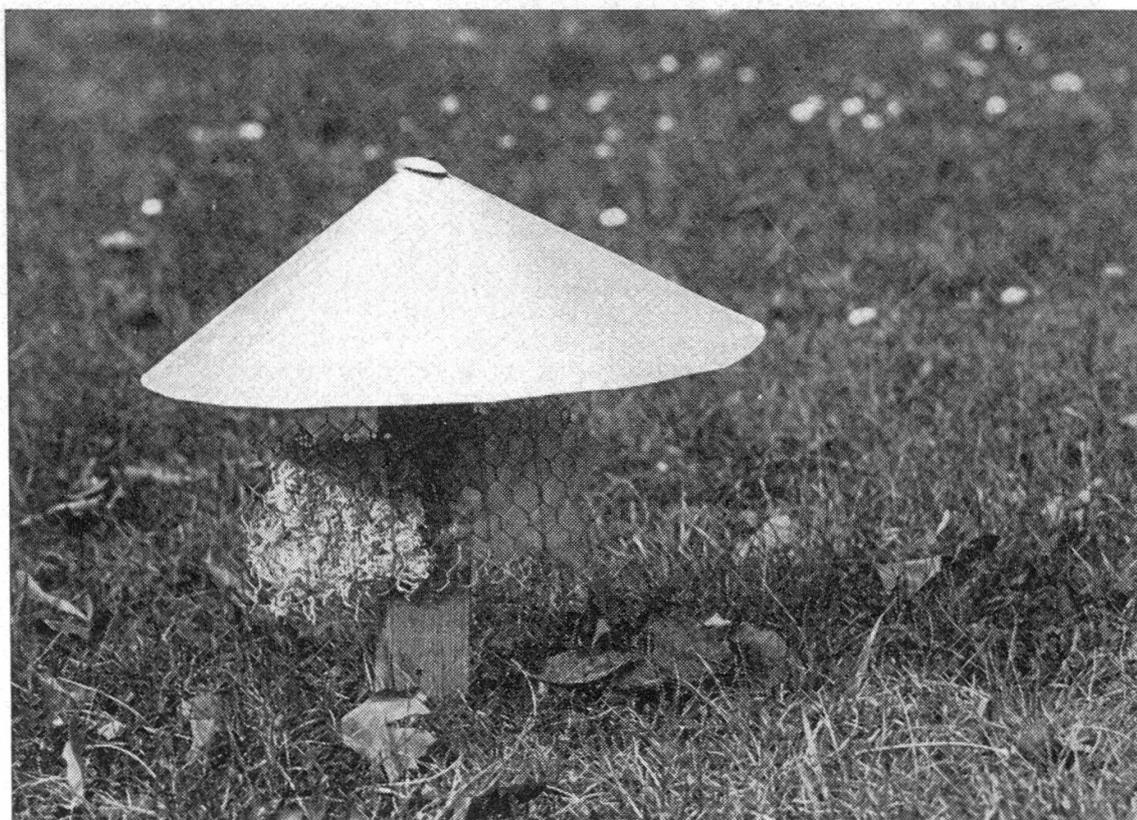
Abbildung 2 Probenehmer. Auf ein Drahtnetz sind Sphagnum-Moos (links) bzw. Glaswolle (rechts) mit Gummibändern aufgespannt worden. Das Drahtnetz wird durch einen Blechhut vor Regen geschützt.
