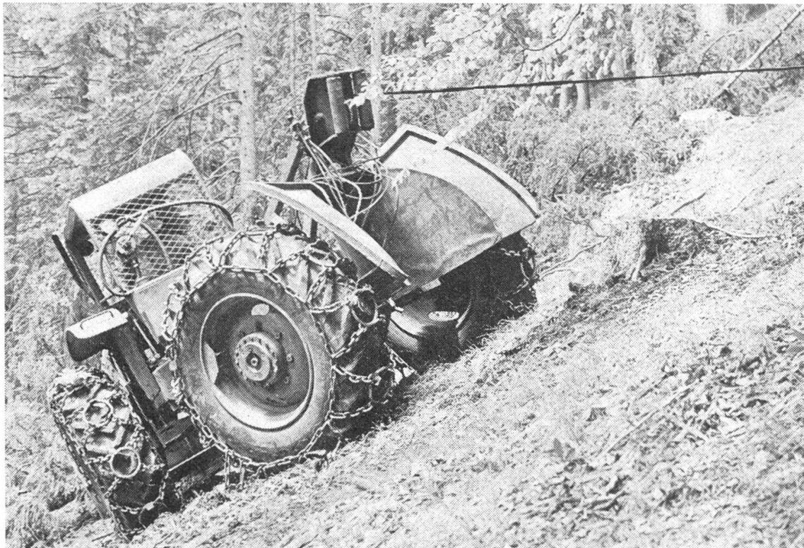
Abbildung 3. Zum Wenden am Steilhang verankert sich der Knickschlepper mit seinem Windenseil an einem oberhalb stehenden Baum und beschreibt, um diesen rückwärtstossend, einen Halbkreis (ÖBF Grossreifling, Steiermark).
