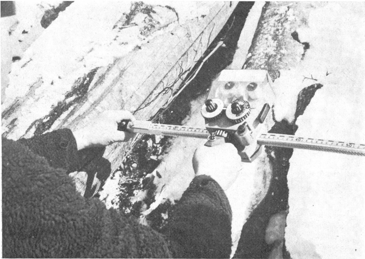
Abbildung 2. Kreuzweises Einmessen des liegenden Holzes mit der Registrierkluppe SP. (Der Rindenanteil des Laubholzes wird bei der Kubierung vom Rechner automatisch abgezogen.)
