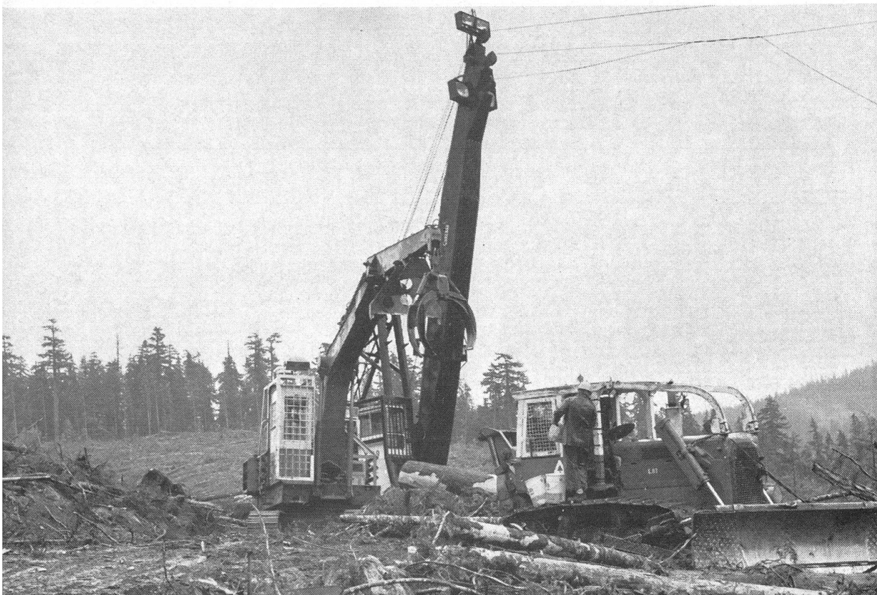
Bild 3. Planierdraupe für den Bau der Lastwagenpisten, Poclain für den Auflad und Graples-Yarder mit einer Reichweite von 130 bis 220 m (Schleppzange an Umlaufseil) gehören zur maschinellen Ausrüstung für Rücken und Verlad im Wald von MM Bloedel auf der Vancouver-Insel.
