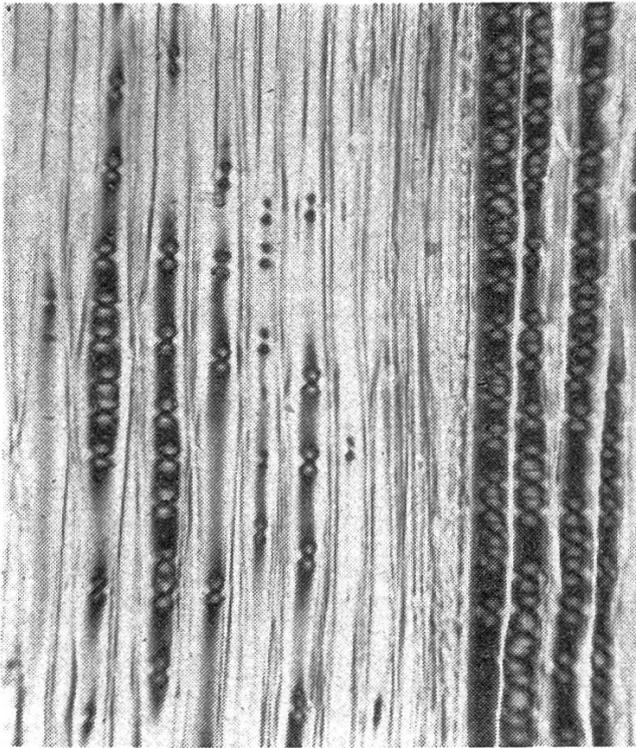
Abbildung 1. Radialschnitt durch Holz von *Pinus strobus*. Im rechten Drittel des Bildes liegt eine Jahrringgrenze. Die Hoftüpfel in den Längstracheiden werden im polarisierten Licht deutlich hervorgehoben (Vergr.: 13 : 1).
