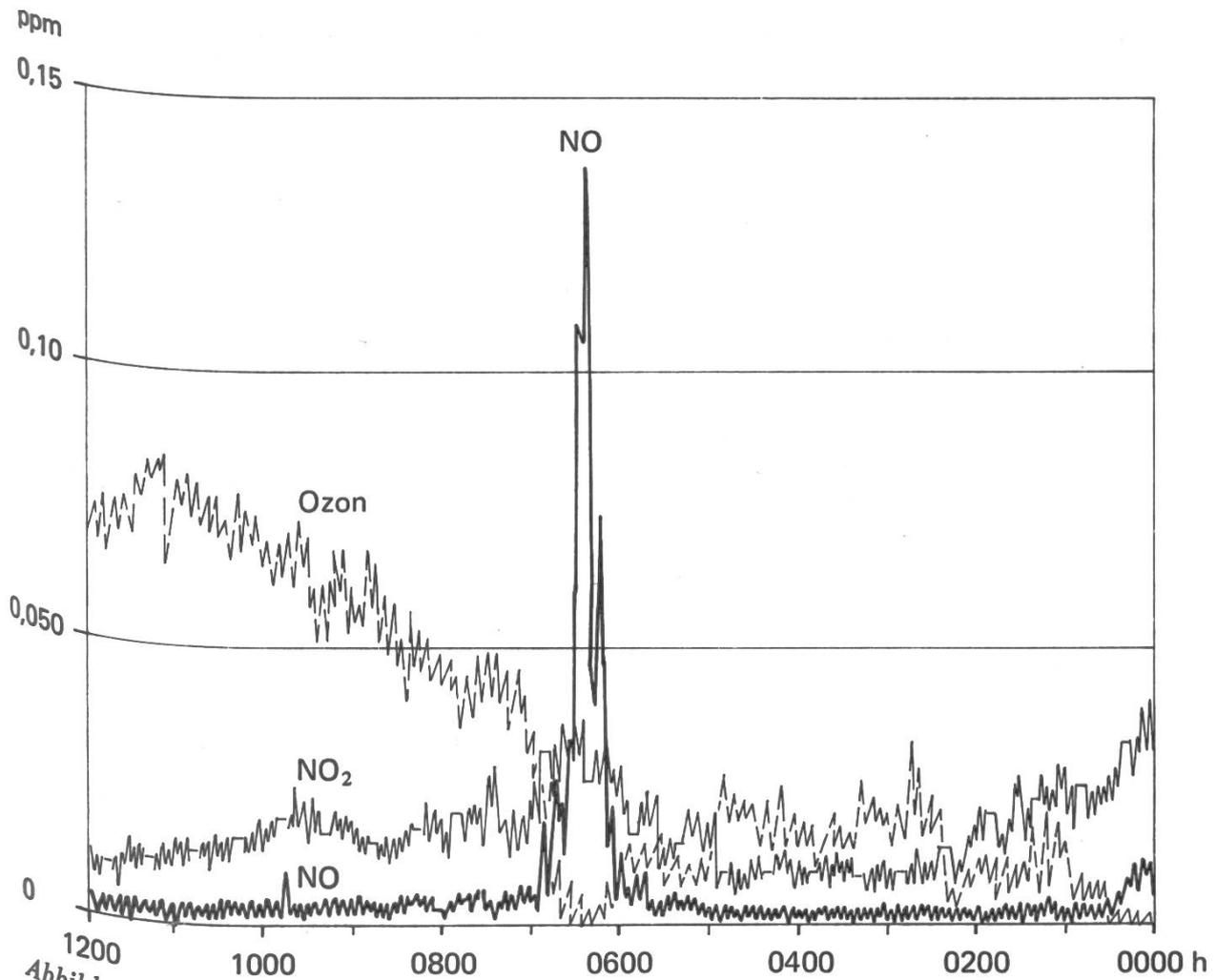
Abbildung 1. Kontinuierliche Messung und Registrierung von Ozon, NO und NO<sub>2</sub> der Aussenluft.
