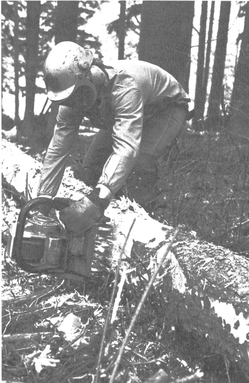
Abbildung 1 Motor-manuelle Stammholzentrin- dung am Hiebsort. Die Gesamtbelas- tung des Wald- arbeiter ist infolge statischer Arbeit und ungünstiger Körperhaltung un- verantwortlich gross. Der «Biber» ist nicht das geeig- nete Mittel zur «Mechanisierung» auf der Bestandes- fläche. (Foto: Bildarchiv BAF)
