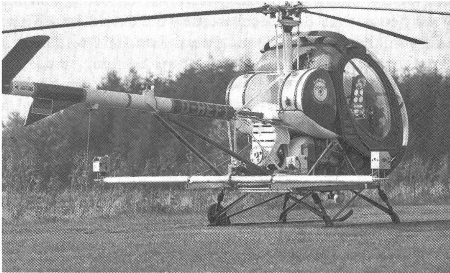
Abbildung 1b: Kameraausrüstung wie auf Abbildung 1a; Montage an einem leichten Helikopter Hughes 300. (Die Langfilmkamera, teilweise verdeckt, befindet sich unterhalb der Helikopter-Batterie.)
