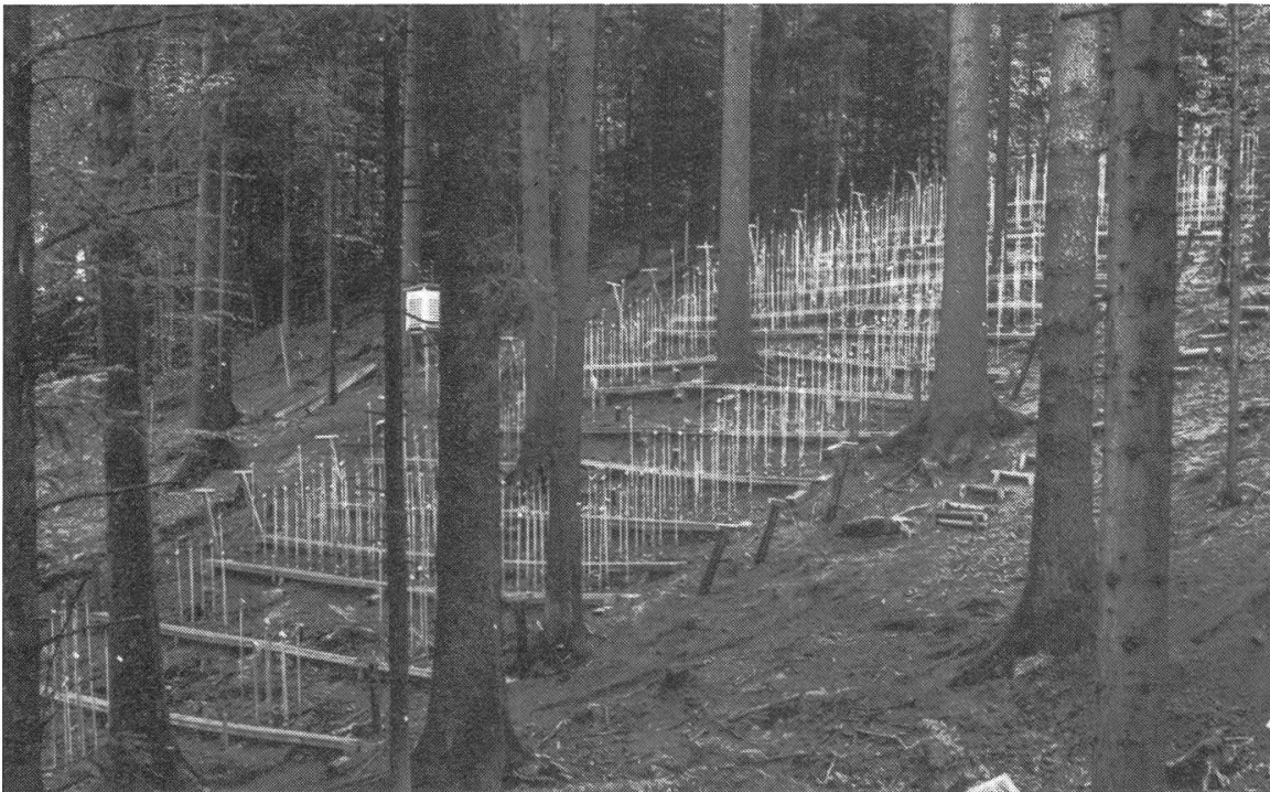
Abbildung 1. Ansicht der Versuchsanlage im Gemeindewald von Meggen (LU). Deutlich erkennbar sind die in Linien angeordneten Tensiometer.
