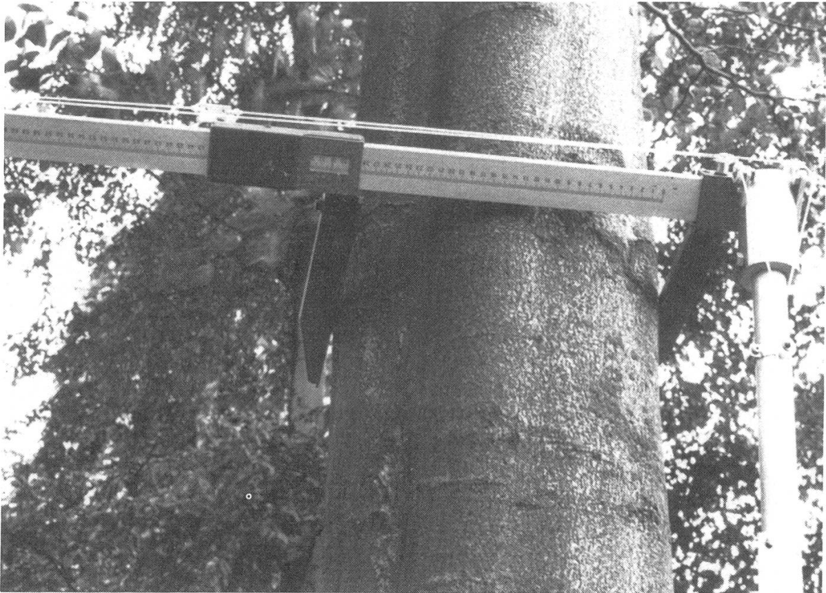
Abbildung 3. Kluppe zur Messung oberer Stammdurch- messer in 3 m, 5 m, 6 m und 7 m Höhe (Nach Rhody).
