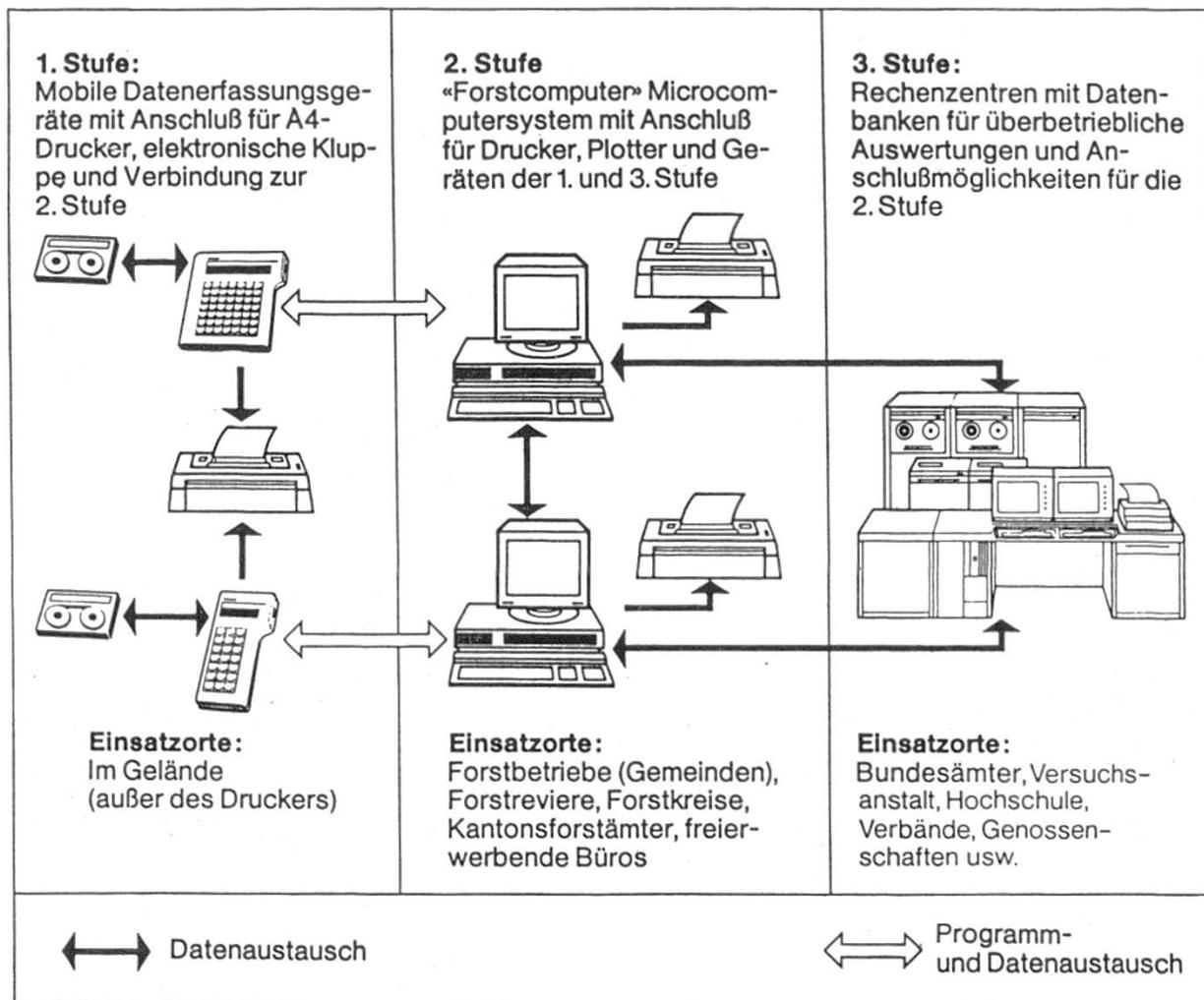
Abbildung 1. Verbindung von 3 Hardwarestufen.
