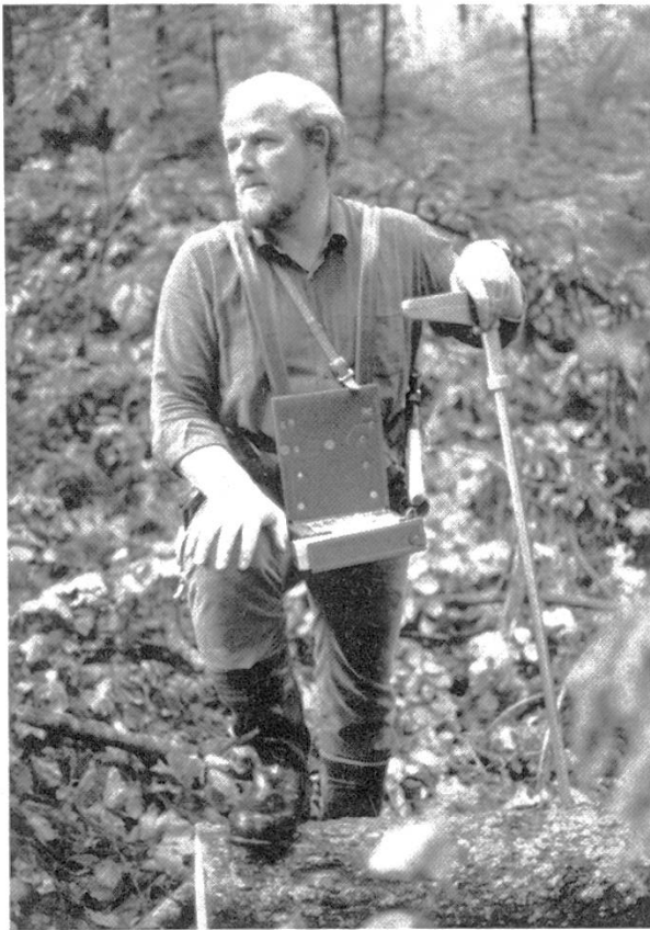
Abbildung 3. Datenerfassung im Wald: zum Beispiel Siemens-Mobida in Spezialtragetui.
