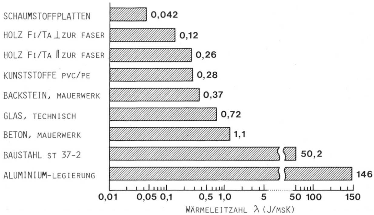
Abbildung 4. Wärmeleitfähigkeit ausgewählter Werkstoffe. Angaben aus (6) und (7).
