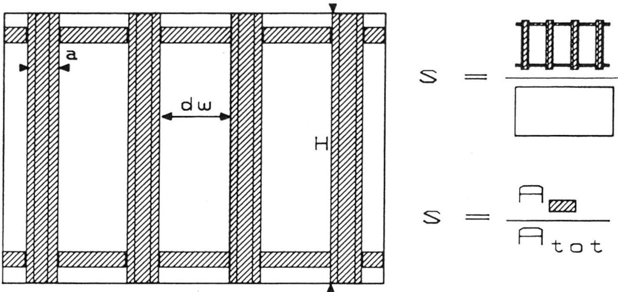
Abbildung 4. Definition des Füllungsgrades  $s$  anhand des Schneerechens.
