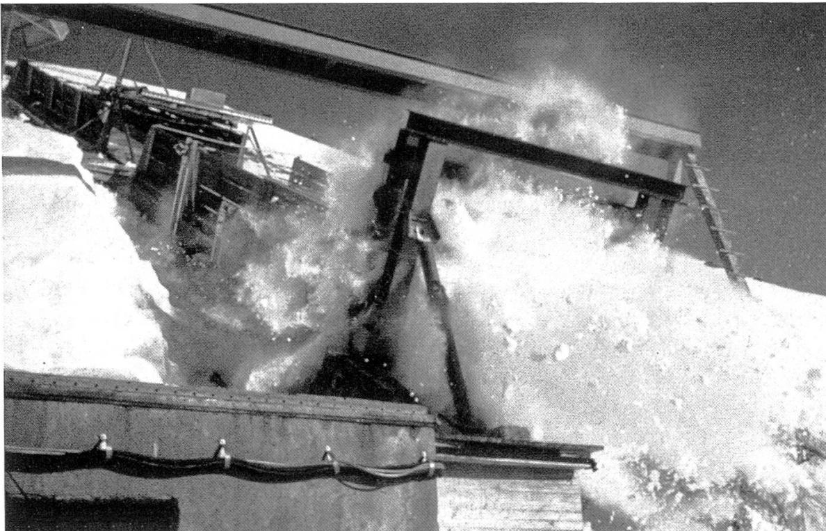
*Abbildung 1.* Aufprall eines Schneeblocks auf Schneebrücke.
