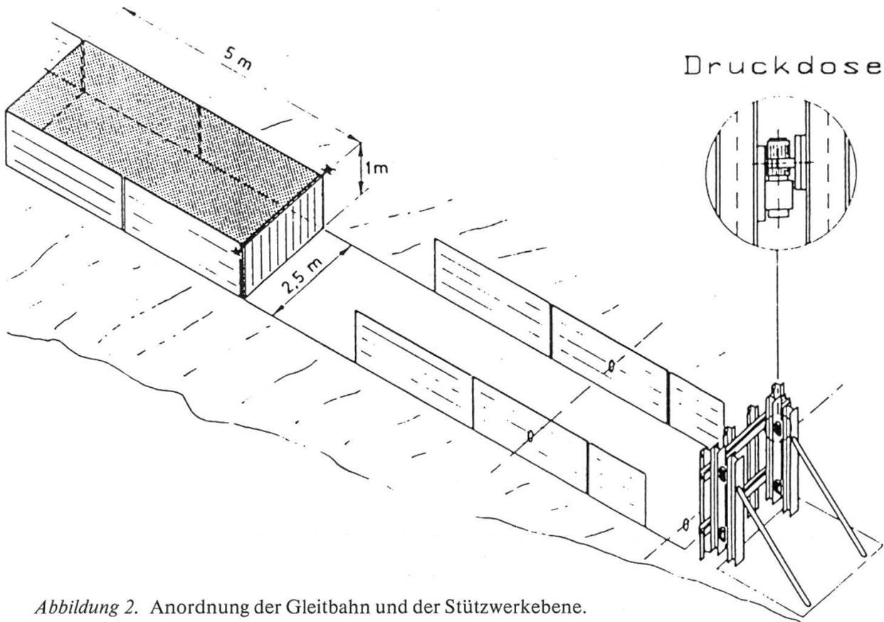
Abbildung 2. Anordnung der Gleitbahn und der Stützwerkebene.
