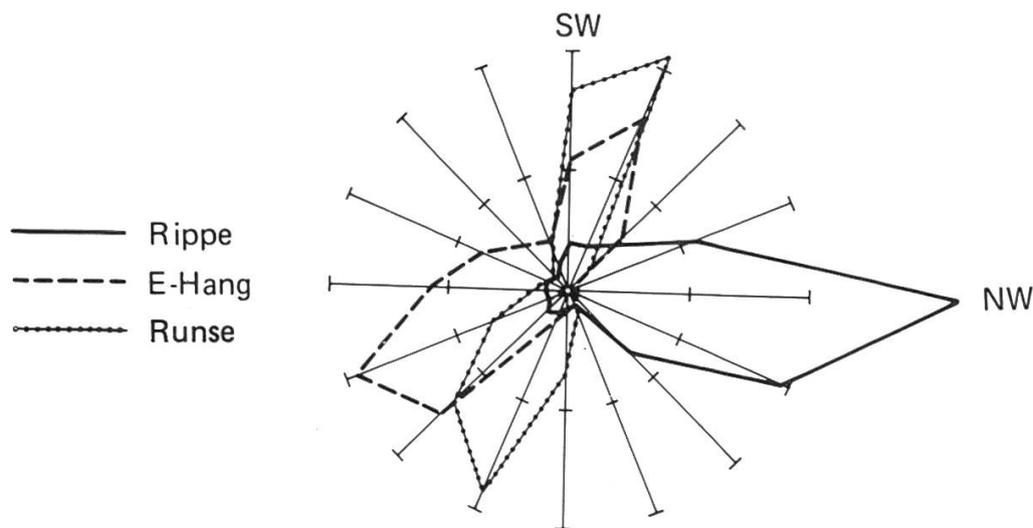
*Abbildung 3.3 d.* Windrosen des Windweges auf dem «Arvengrat» des Stillberges sowie auf dem Osthang und in der Runse im Lee dieser Geländerippe, die senkrecht (aus NW) angeströmt wird. Messungen von Turner (in *Nägeli*, 1971: Fig. 31C).
