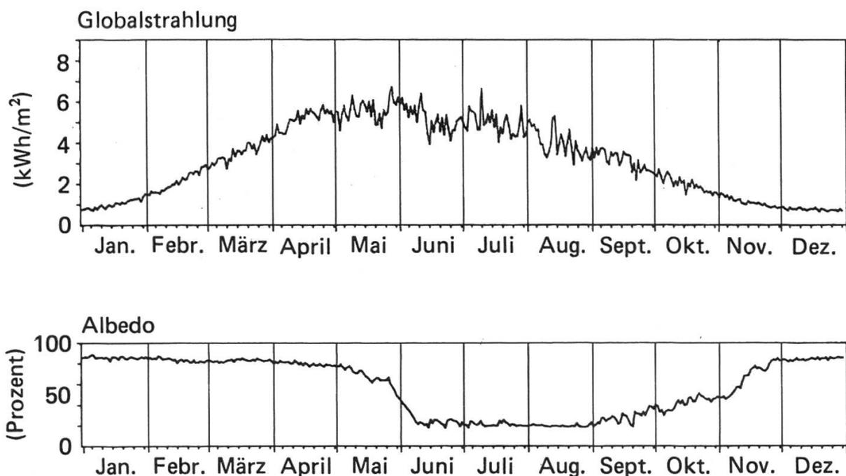
Abbildung 3.2 c. Jahresgang der Globalstrahlungs-Tagessummen (kWh/m²) und der Hangreflexzahl (Albedo) (%) an der meteorologischen Station Stillberg. Mittelwerte der Periode 1975 bis 1984.
