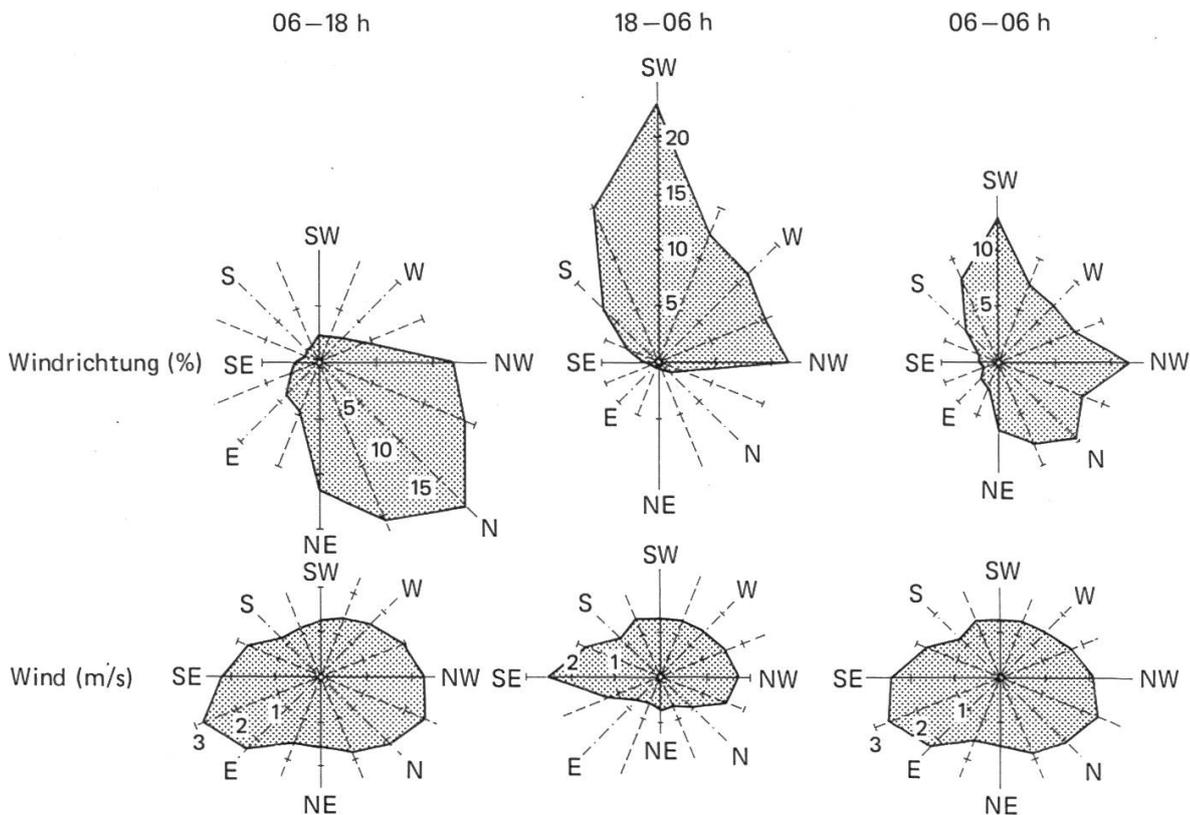
Abbildung 3.2f. Windrichtungshäufigkeit und mittlere Windgeschwindigkeit (m/s) pro Richtung der 16teiligen Windrose an der meteorologischen Station Stillberg für den ganzen Tag sowie für Tag und Nacht getrennt (Vegetationsperioden 1962 bis 1965). Aus Nägeli (1971).
