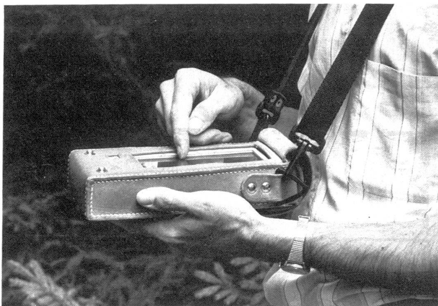
Abbildung 1. Arbeit mit dem Datenerfassungsgerät Epson-Handy Terminal (EHT-10) im Wald.
