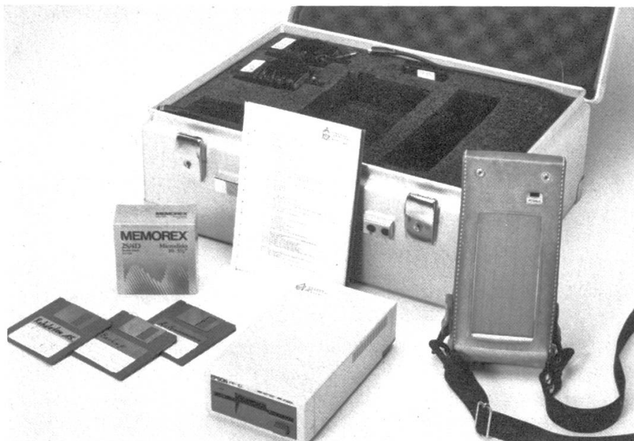
Abbildung 3. Ausrüstung einer Datenerfassungsgruppe: Disketten, Transformer, Diskettenlaufwerk (PF-10), Datenerfassungsgerät (EHT-10) und Gebrauchsanleitung.
