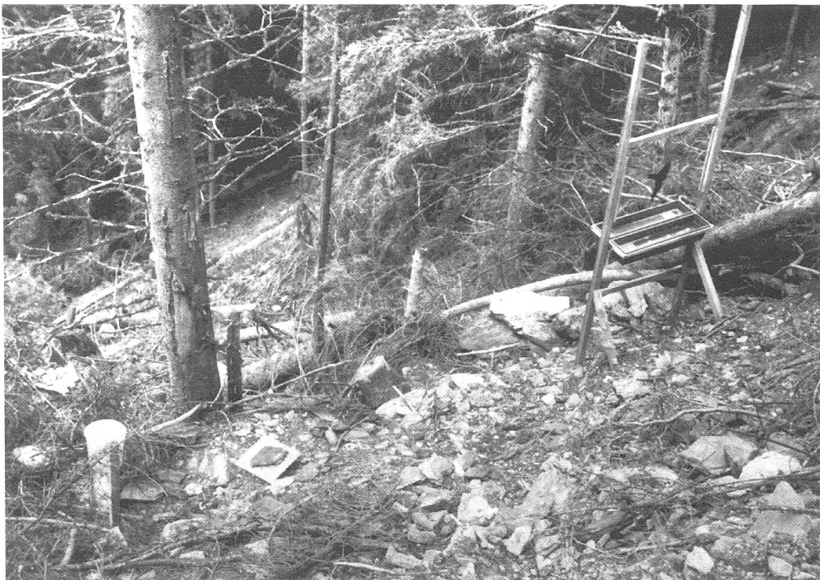
Abbildung 1. Insektenfallen-Set in Pfäfers: Gelbfalle (Eimer, unten links), Bodentrichterfalle (mit Abdeckung, Mitte links), Fensterfalle (oben rechts).
