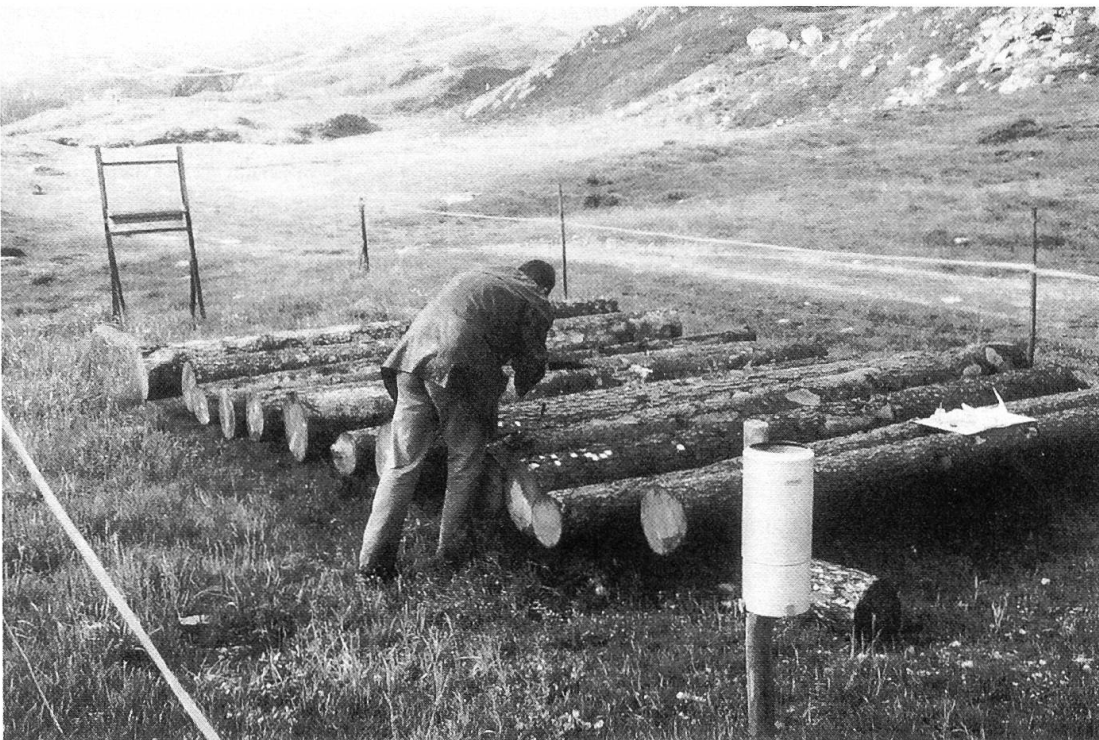
Abbildung 1. Versuchspolter auf der Passhöhe des Lukmaniers (1920 m ü. M.); im Vordergrund der Regensammler, hinten eine Fensterfalle.
