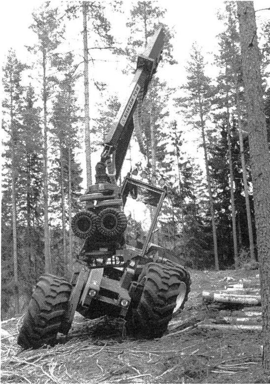
Abbildung 3. Spezialisierter Radharvester für schwieriges Gelände, SKOGSJAN 487 XL. Beim Einsatz von konventionellen Radmaschinen unter extremen Geländebedingungen ist zu bedenken, dass nicht alles, was in Einzelfällen technisch machbar ist, auch wirtschaftlich und unter dem Aspekt der Arbeitssicherheit sinnvoll sein muss, insbesondere, wenn solche Einsätze oft erfolgen sollen. (Foto WSL)
