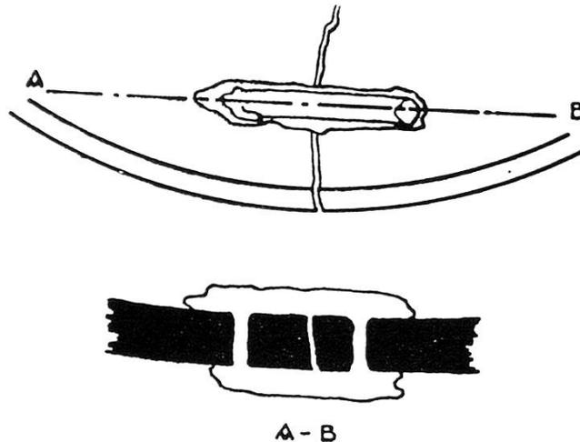
Abbildung 3. Tellerflick aus Blei, von oben und im Querschnitt
