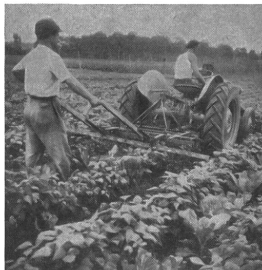
Fig. 2 b: «Farmall-Cub». La position du cultivateur.
