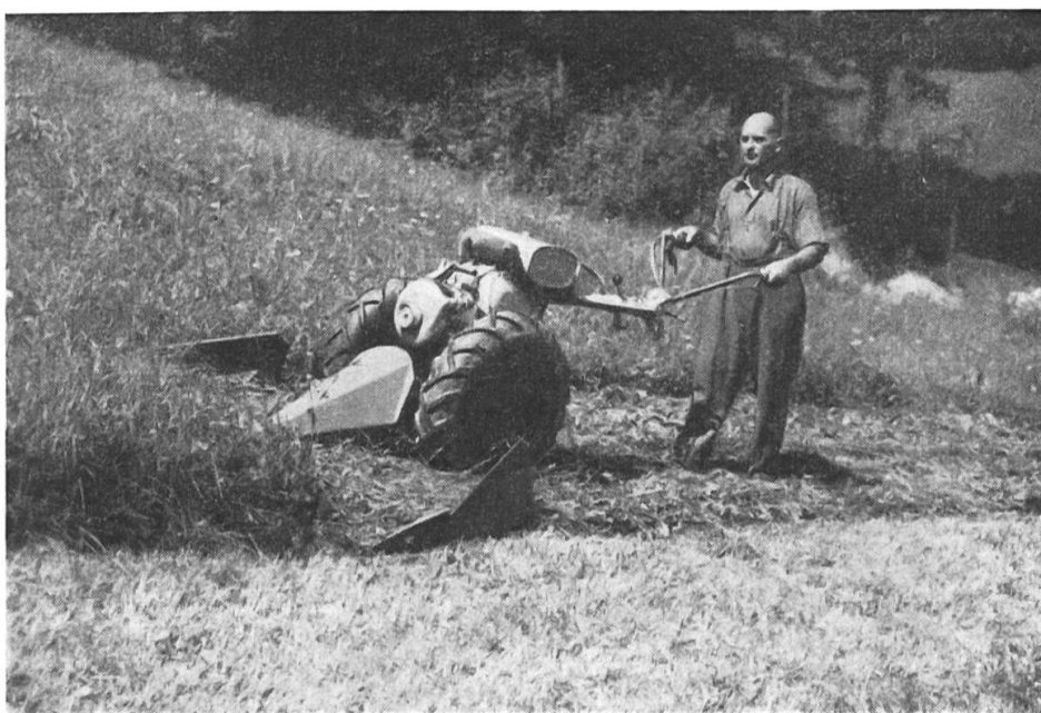
Fig. 8: Tracteur à un axe «Rapid S» au moyen d'une barre frontale.
