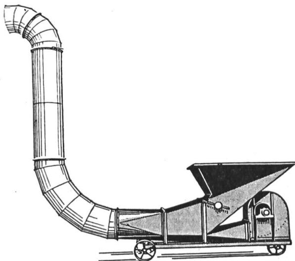
**Appréciation générale:** Le déchargeur de fourrage et de gerbes par ventilation Zumstein est conçu pour le transport du foin et du regain, de gerbes liées à main ou à la machine ainsi que de petites bottes de paille. L'engrangement d'une charge de 1600 à 2000 kg. de foin, regain ou gerbes est exécuté en 20 à 30 minutes. La puissance nécessaire pour actionner la machine travaillant avec des conduites de 500 mm. de diamètre est la suivante:
