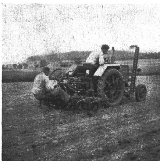
Fig. 1: Roues de grand diamètre améliorant l'adhérence et diminuant la compression du sol.
