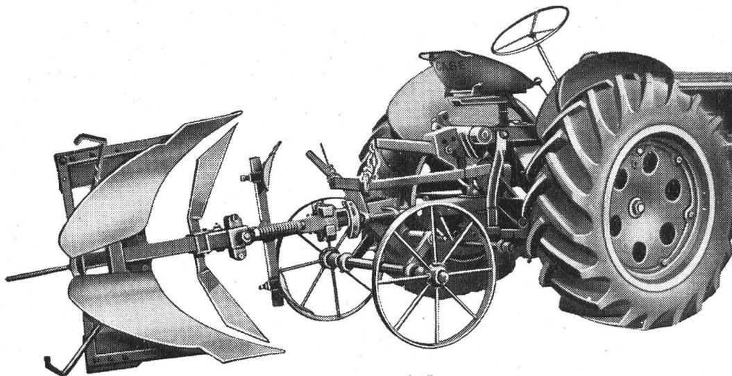
Modèle spécial à goupille de cisaillement avec relevage mécanique à bras.
