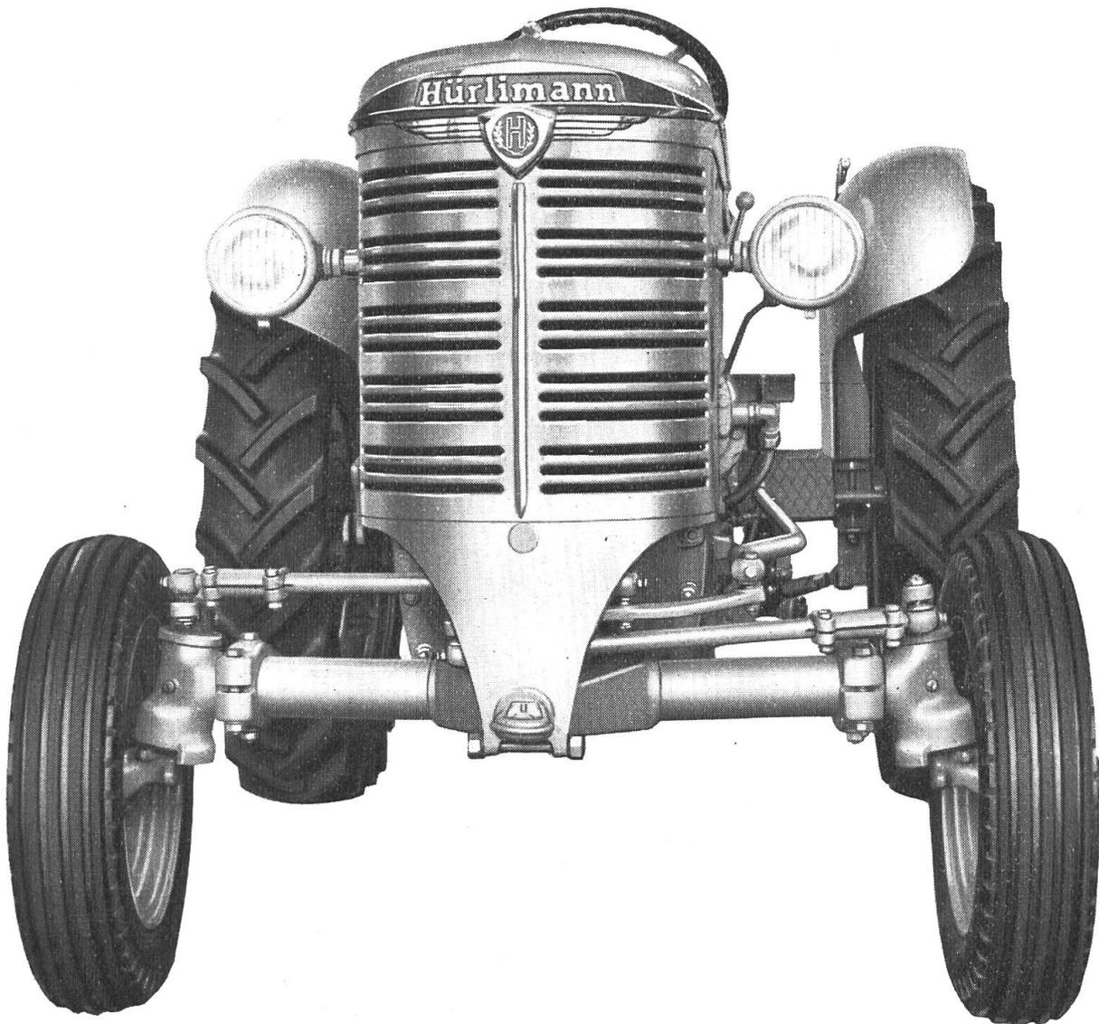
L'essieu avant est télescopique et repose sur des supports d'acier coulé. L'essieu et la barre d'accouplement sont extensibles et permettent de varier la voie. Il y a lieu de remarquer la nouvelle conception des articulations des roues avant (fusées et pivots de fusées).
