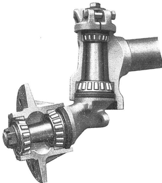
L'articulation des roues avant (fusée et pivot de fusée). — Détail des paliers tronconiques à rouleaux. Ces paliers peuvent être facilement réajustés, ce qui élimine le jeu des roues avant, si incommode.
