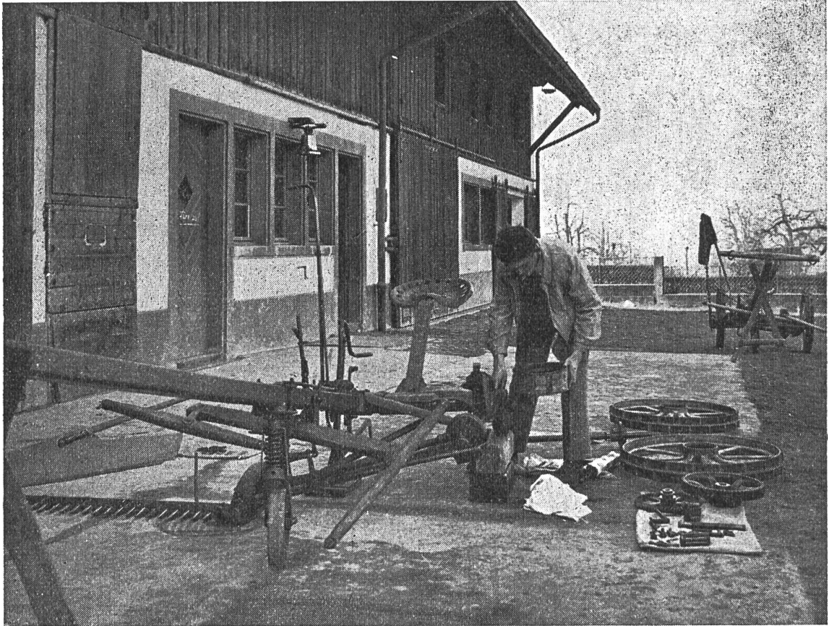
Fig 11a: Révision et nettoyage à fond d'une faucheuse.
