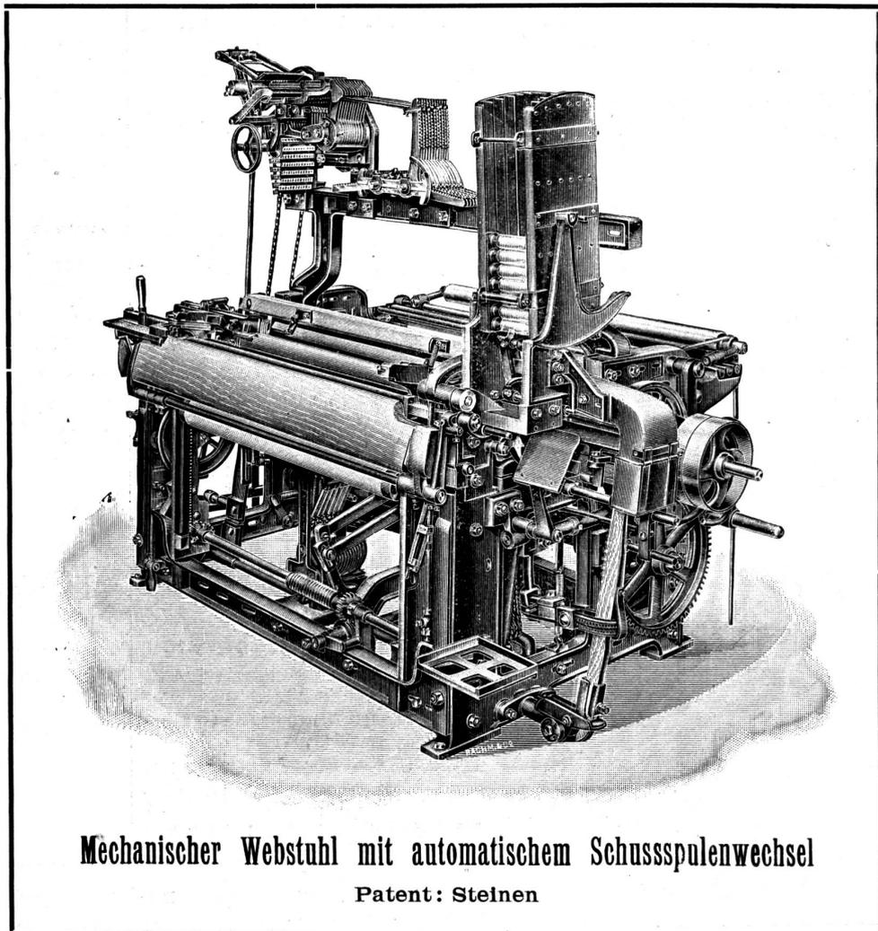
Mechanischer Webstuhl mit automatischem Schusspulenwechsel
