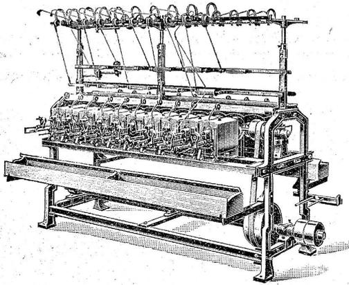
**Pat. Kreuzschußspulmaschine Produktiv GK**
