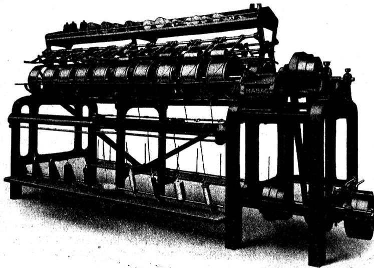
Abb. 1. Gesamtansicht der Kreuzspulmaschine, System Hirt-Kappeler, D. R.-P. (M a b a g, Maschinenbau A.-G. Langenthal, Langenthal, Schweiz.)
