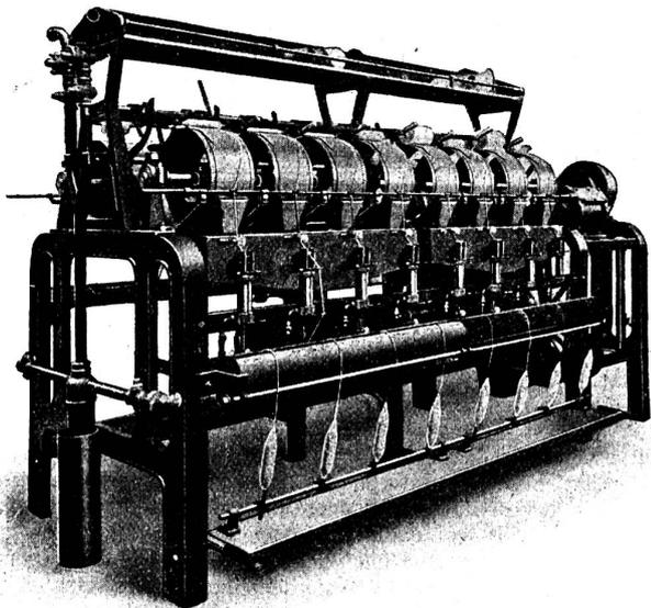
Abb. 3. Garnsengmaschine für Gas, System „Mabag“.
