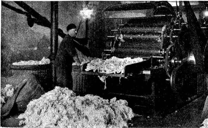
Wolltuchfabrikation: Reißwolf zum Zerreißen und Mischen der Wolle.
