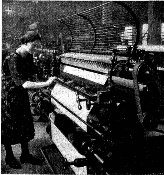
Wolltuchfabrikation: An der Schermaschine. Die aus dem Gewebe hervorstehenden Enden werden gleichmäßig abgeschnitten.
