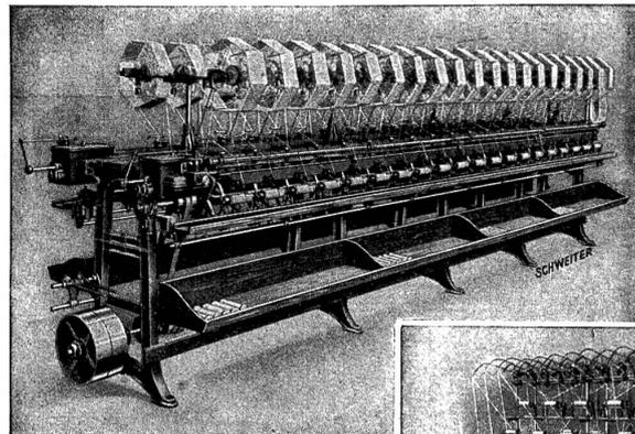
Pat. Spindellose Windmaschine
