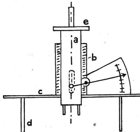
rat kann wie in beiliegender Skizze 1 angegeben konstruiert sein. Hiermit ist eine Messung der Spannung mit hinreichender Genauigkeit möglich. Der Apparat erfordert aber gleiche Lage der einzelnen Ketten, d. h. die Entfernung vom Streichbaum bis Brustbaum muß
