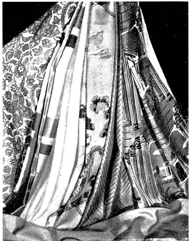
Nach verschiedenen Verfahren bedruckte Glasfasern-Dekorationsstoffe.
