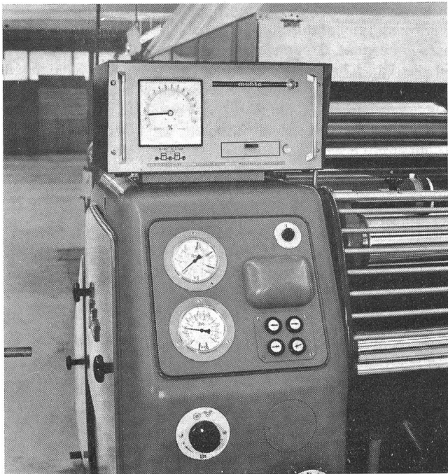
Abb. 11 Dehnungs- und Krumpfungsmessgerät (an einer Schlichtmaschine)
