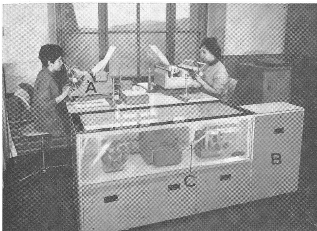
Fig. 18 Fabrication d'une bande-pilote pour l'étampage automatique d'un monofil A = machine à écrire B = programmatrice C = bande-pilote
