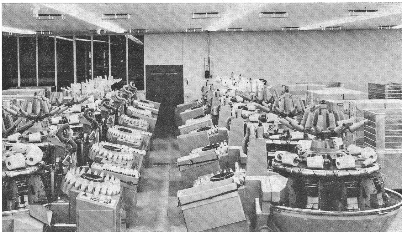
Kreuzspulautomaten CA 11 in einer modernen Weberei im Einsatz. Im rechten Bildrand ist eines der Materialdepots sichtbar, wo die Spulerin ca. alle Stunden einmal die aus der Spinnerei angelieferten Kartons mit vollen Kopsen holt und sie direkt neben das zentrale Kopsmagazin der Automaten stellt, so dass die Kopsen ohne nochmaliges Umladen vorgelegt werden können
