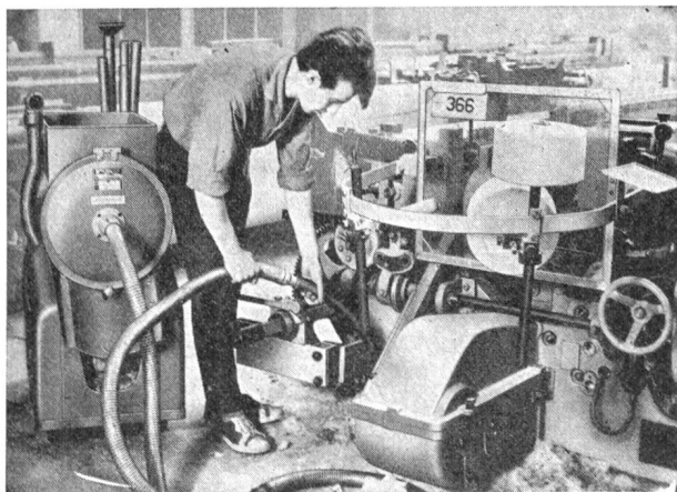
Absaugapparat bei der Webstuhlreinigung. Sogar Schmierlöcher werden einwandfrei ausgesaugt. Bei der Zwischenreinigung können Schützenkästen und Geschirre rasch und ohne Beschmutzung des Gerätes gereinigt werden
